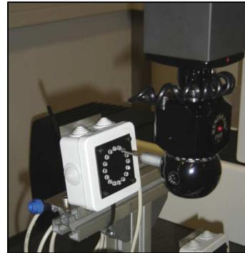
Figuras 5 e 6 – Equipamento de referência no ensaio dimensional (à esq.) e pormenor da medição de led do alvo (à dir.).
