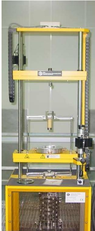
Figura 2 - FSM de 50 N a 5 kN (massas suspensas).
