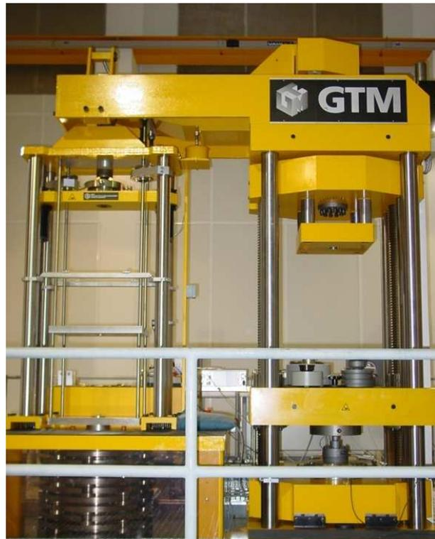
Figura 3 - FSM de 1 kN a 100 kN (massas suspensas) e FSM de 100 kN a 1 MN (alavanca).
